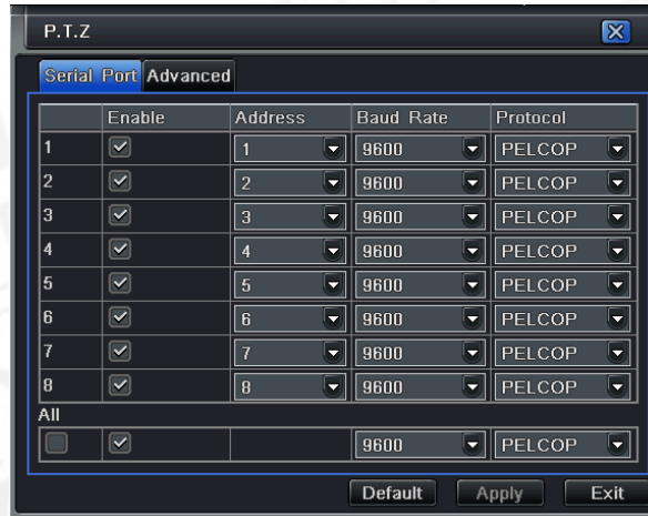
4-37. Ábra: P.T.Z beállítás –soros port
