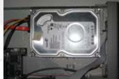
2-1 Ábra: HDD csatlakoztatása
